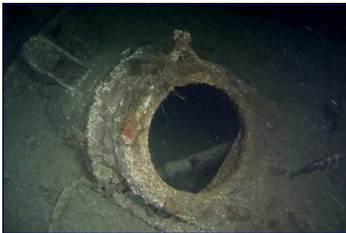
Panneau de chargement des torpilles. C'est par là que W.Schmietenknop parvint à se sauver.
